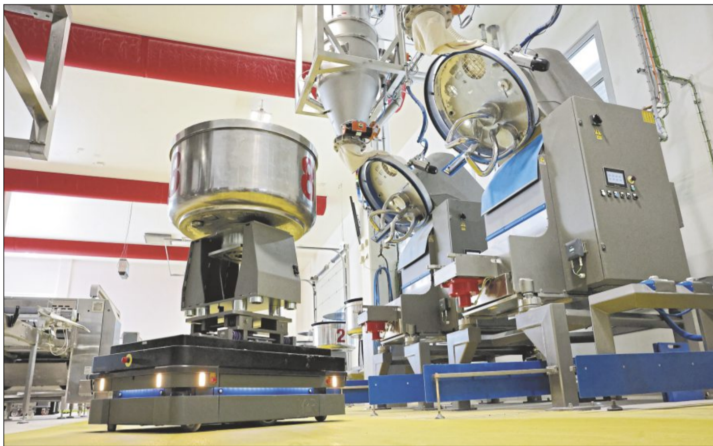
Da fährt die Teigmischung zum Rühren: Ein Bäcker muss hier keine schweren Schüsseln mehr wuchten, alles geht ganz automatisch. Foto: Habermann
